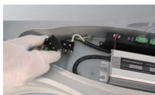
Conexión por conector rápido Quick-connector wiring
