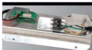
Disipador en V para prevenir acumulación de polvo V heat dissipation to prevent dust stack
